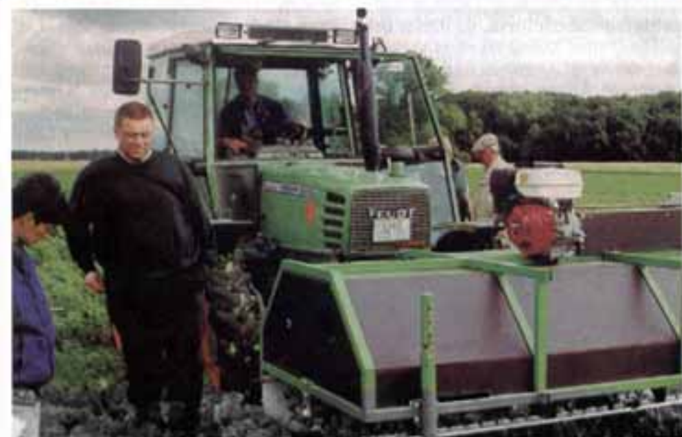
Exakte Einstellung des Hagelsimulators auf dem Versuchsfeld von Strube-Dieckmann.
