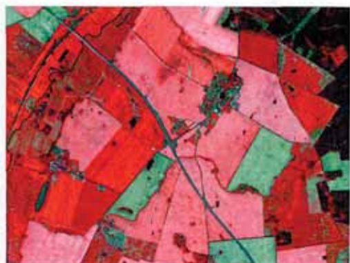
Die rote Signalfarbenkarte vermittelt dem menschlichen Auge einen deutlicheren Eindruck. Dargestellt ist der Nahinfrarot-Kanal.
