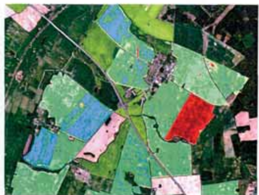
Boden und Pflanzen reflektieren Licht unterschiedlich. Auf Basis der in den einzelnen Farbkanälen gemessenen Unterschiede berechnet das System den Bodenbedeckungsgrad für jeden einzelnen Bildpunkt. Allerdings wird dabei nicht wie bei der Chlorophyllkarte die Fruchtart berücksichtigt.
